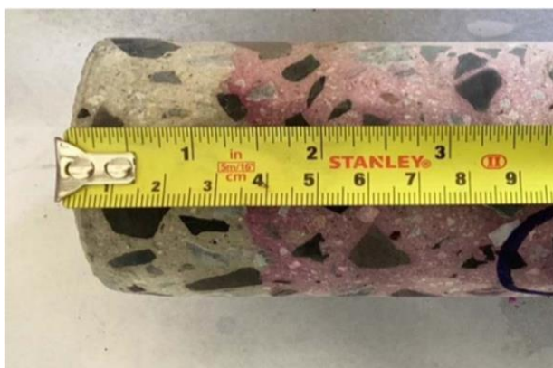
รูปที่ 5 การทดสอบหา Carbonation depth โดยใช้สารละลาย Phenolphthalein(1%) สะพานข้ามแยกบายพาสบ้านบึง (LT)
